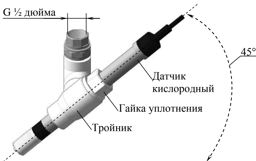
Рисунок 2.9 – Держатель датчика с установленным датчиком кислородным
